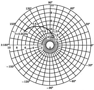
$S_{12e}$   $V_{CE}=6V$   $I_{C}=7mA$   $T_{a}=25^{\circ}C$
