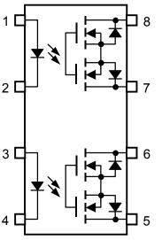
1, 3 : ANODE 2, 4 : CATHODE 5 : DRAIN D1 6 : DRAIN D2 7 : DRAIN D3 8 : DRAIN D4
