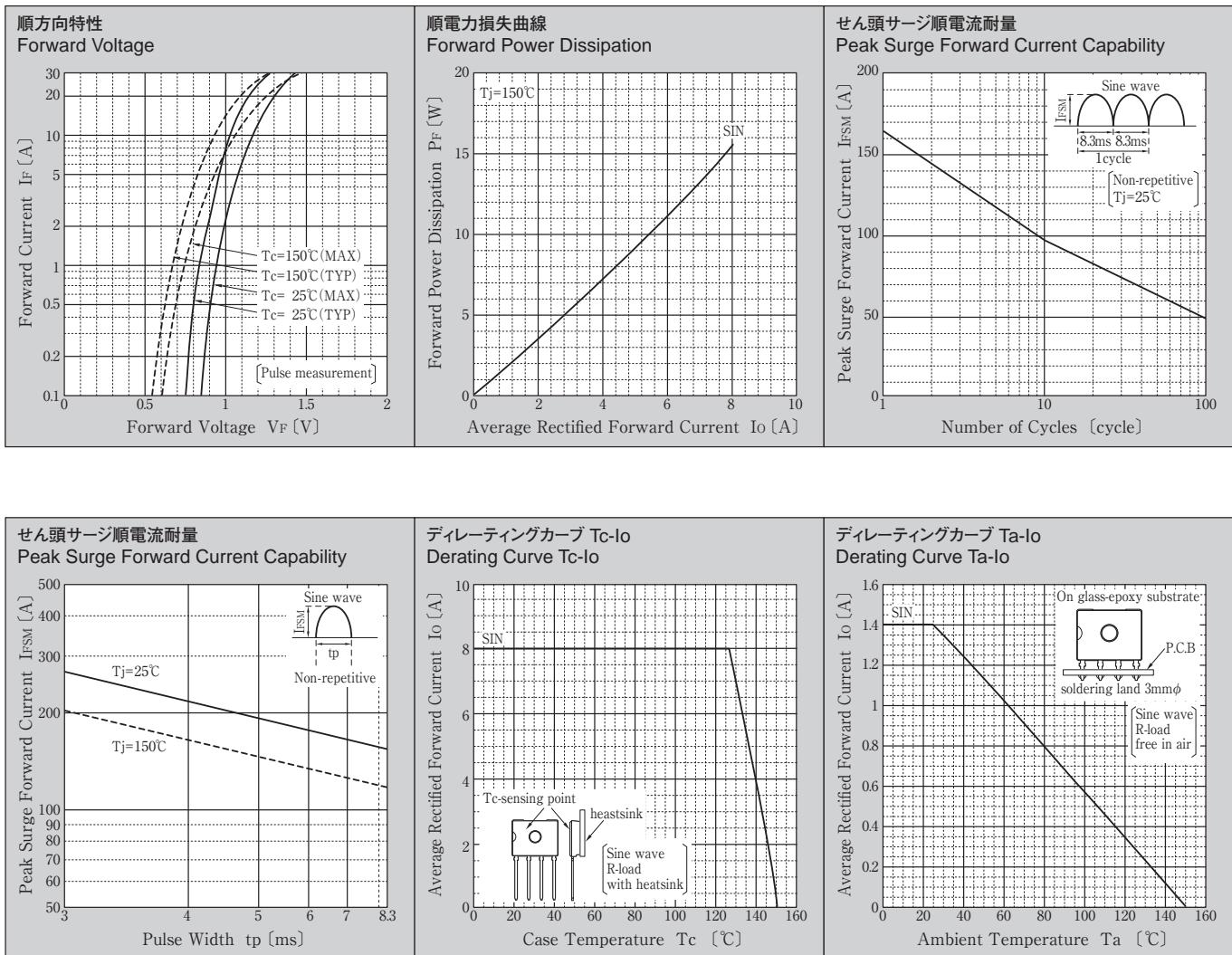
\* Sine waveは50Hzで測定しています。
