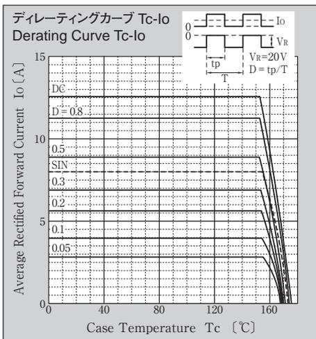
\* Sine waveは50Hzで測定しています。
