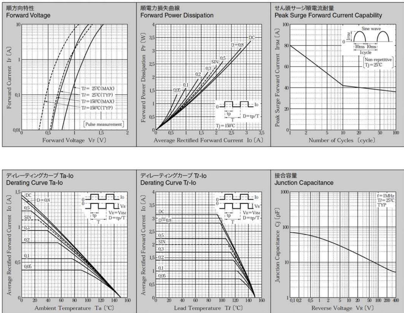
\* Sine waveは50Hzで測定しています。
