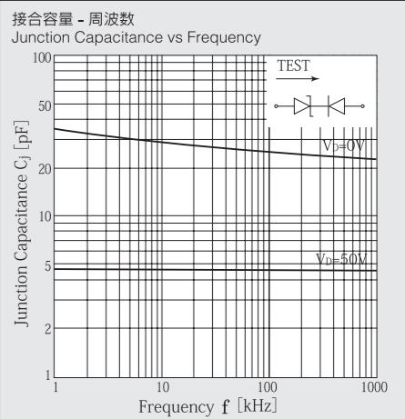
●電気的・熱的特性 Electrical Characteristics (指定のない場合 T<sub>1</sub>=25°C / unless otherwise specified)
