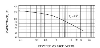
Fig. 4-TYPICAL JUNCTION CAPACITANCE
