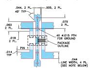
IES: 1.TRACE WIDTH IS SHOWN FOR ROGERS RO4350B WITH DIELECTRIC THICKNESS 0.020" ± 0.0015"; COPPER: 1/2 0Z. EACH SIDE. FOR OTHER MATERIALS TRACE WIDTH MAY NEED TO BE MODIFIED.
