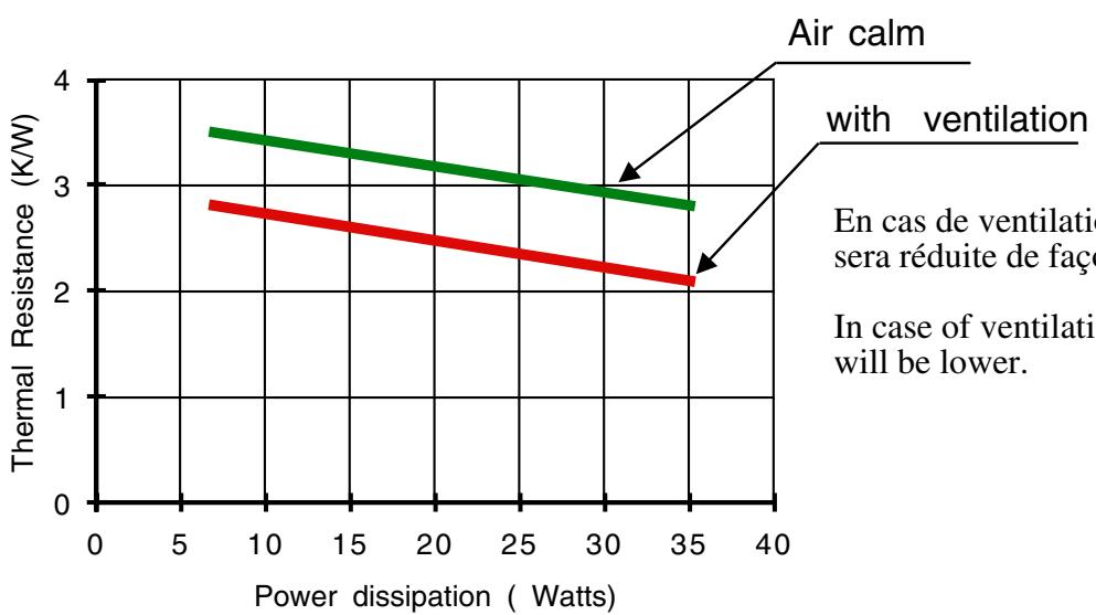
En cas de ventilation, la résistance thermique sera réduite de façon significative.
