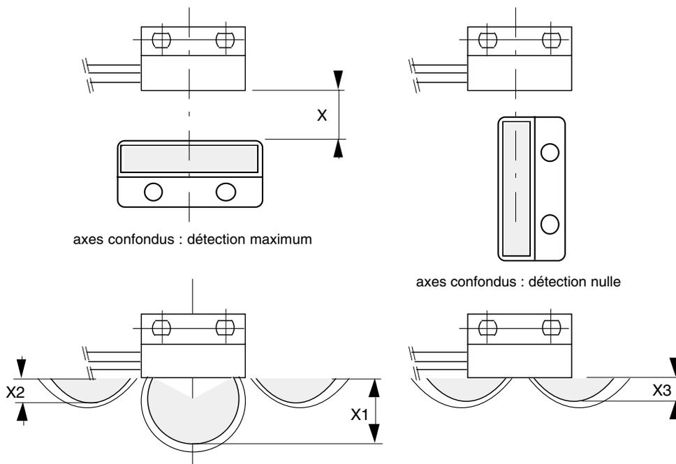
Distances typiques de détection par rapport à l'enclenchement entre le boîtier de l'aimant et celui du détecteur en mm ( $\pm 1,5$  mm); Echelle 0,8
