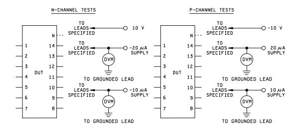
FIGURE 17. Threshold-voltage test circuit.
