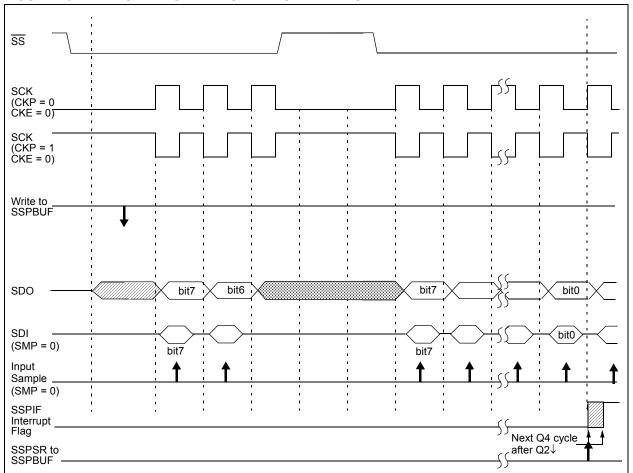
FIGURE 16-5: SPI MODE WAVEFORM (SLAVE MODE WITH CKE = 0)
