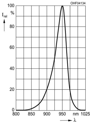
**Radiant Intensity** <sup>3) page 13</sup>**Strahlstärke** <sup>3) Seite 13</sup>
