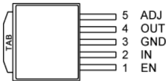
5-Pin TO-252 (D-Pak) Adjustable Voltage (D) MIC29302AWD
