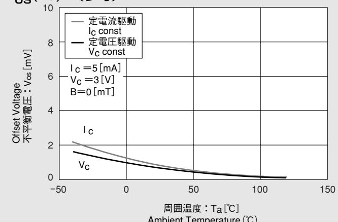
定電圧駆動  $R_{in}=850 \text{ } \Omega$ 、 $V_{os}=0.8 \text{ } \mu\text{V}$  [ $V_c=3 \text{ V}$ ] の例
