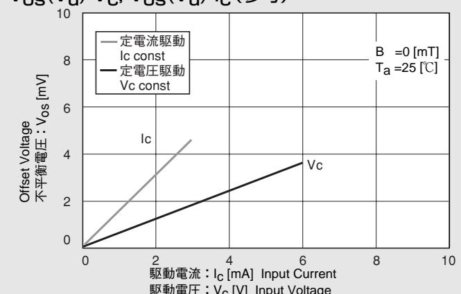
定電圧駆動  $R_{in}=2659\ [\Omega]$ 、 $V_{os}=3.44\ [mV]$  [ $V_c=6\ [V]$ ] の例
