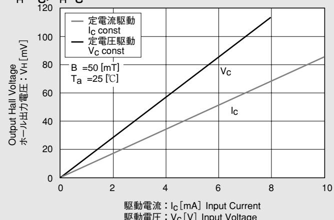
V<sub>os</sub>(V<sub>u</sub>)-V<sub>C</sub>, V<sub>os</sub>(V<sub>u</sub>)-I<sub>C</sub>(参考)
