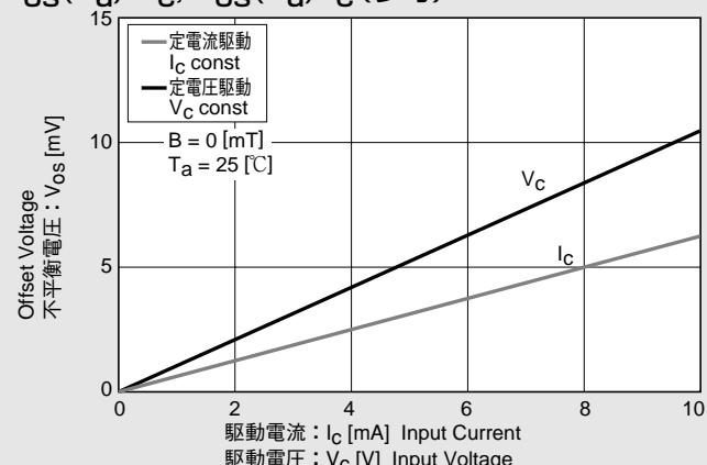
定電圧駆動 R<sub>in</sub>=600 [Ω]、V<sub>os</sub>=6.3 [mV] [V<sub>c</sub>=6 [V]] の例
