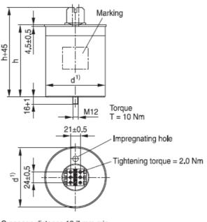
Creepage distance 12.7 mm min. Clearance 9.6 mm min.
